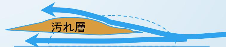
水の浸透が界面全体に進むと、汚れ層は大きく崩壊せず、がばっと浮き上がるように剥離する
