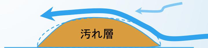
汚れ層の崩壊より大きな速度で、汚れと下地の界面へ水の浸透が進む
